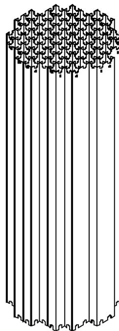
FIG 2; HOLTEC MPC FUEL BASKET
